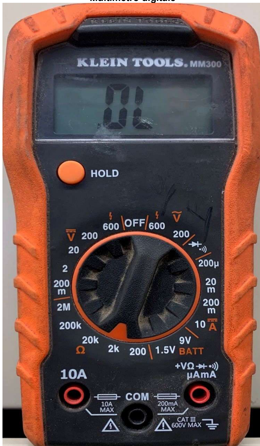
MULTIMETRO DIGITALE 1 Visualizzato con l'intervallo di 2000 Ohm selezionato. Questo intervallo è utilizzato per misurare la resistenza in cavi, semiconduttori e diversi dispositivi sensori.
